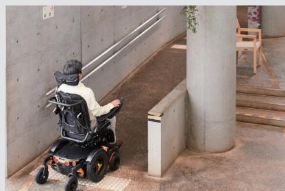
傾斜のある路面でも駆動輪が浮かずに走行可能
