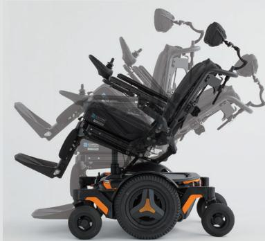
下り坂の手前で座面角度を倒せば、転落の不安も解消
