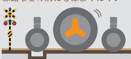
路面状況に走行が影響されにくいサイズのタイヤ。側溝のふたや線路、門扉のレールなどさまざまな溝にはまりにくいので、目的地への経路も自由度が増します。
